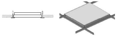
5.6 Накладной монтаж светильников осуществляется на ровные потолки из любого строительного нормально воспламеняемого материала. В потолке должно быть предусмотрено отверстие для проводов питания светильника. Светильники должны быть надежно зафиксированы на поверхности при помощи саморезов (нет в комплекте поставки). Рассеиватель закрепляется по окончании монтажа светильника на поверхность:
