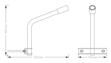
Кронштейн **ДС-2** ТМ Feron предназначен для крепления консольных светильников.
